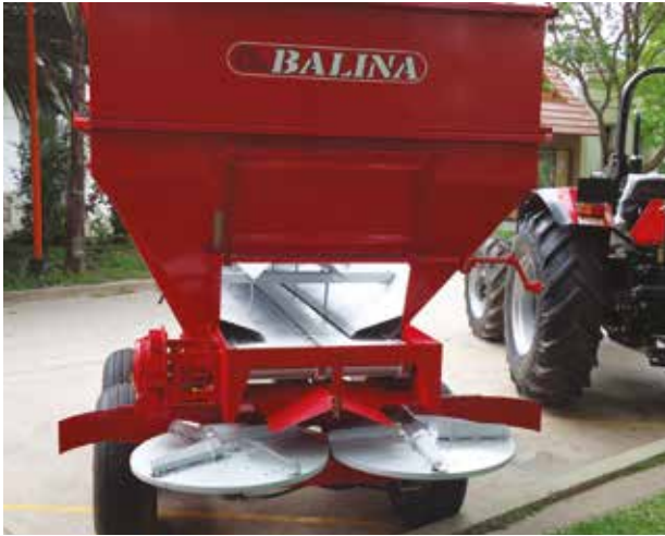
Figura 4. Cinta transportadora del fertilizante a los platos distribuidores y guillotina que permite el pasaje de mayor o menor altura del fertilizante.
