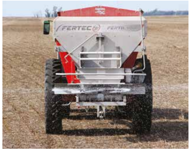
Figura 5. Funcionamiento de los platos distribuidores.
