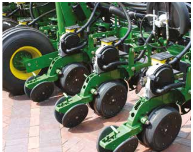
Figura 9. Sistema de fertilización simultánea con la siembra.
